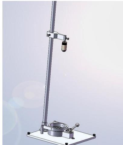
Le « Dart Drop Tester » permet de quantifier selon la norme ISO 7765 la résistance à la perforation d'un film plastique par chute d'un percuteur sur un échantillon de polymère. Utilisé sur du film de banderollage, d'operculage ou toute autre feuille souple, une mesure de cette valeur permet un allègement au plus près des besoins correspondant à l'utilisation.
