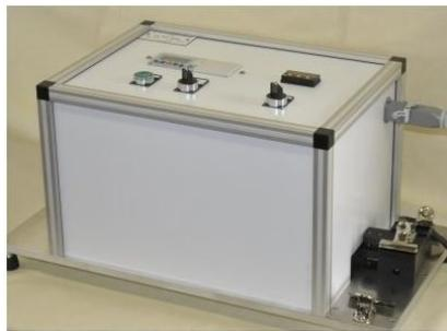
L'« Ink Rub Tester » permet de vérifier la résistance à l'abrasion de deux surfaces en contact (carton/étui, intercalaire/étiquette...) selon un protocole normé TAPPI T830, ou test Sutherland. Le principe consiste à mettre en contact deux échantillons de matériaux, avec une charge définie, et d'effectuer un nombre de cycles aller-retour afin de déterminer si une abrasion apparaît au contact.
